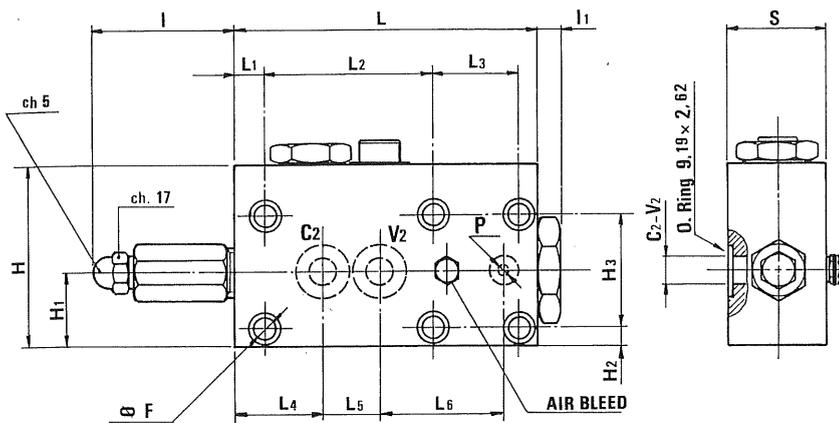
Queste valvole sono caratterizzate dall'alto rapporto di pilotaggio che le rende molto vicine come funzionamento alle valvole unidirezionali a sbloccaggio oleodinamico. La configurazione con camera opposta alla pressione di pilotaggio a pressione atmosferica e l'alto rapporto di pilotaggio rendono la valvola particolarmente idonea per circuiti ove siano presenti contropressioni anche forti sul ramo «V<sub>2</sub>».
