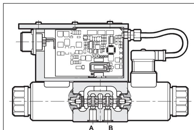
— La valvola DSE3G è un distributore ad azione diretta a comando elettrico proporzionale, con superficie di attacco rispondente alle norme ISO 4401 (CETOP RP 121H).
