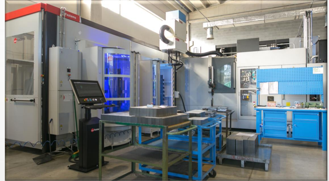
Factory-Manufacturing-System TOYODA (Bearbeitung von Stahl): Werkzeugmagazin mit 504 Werkzeugen / Fastems-Palettenlager mit 16 Stationen
