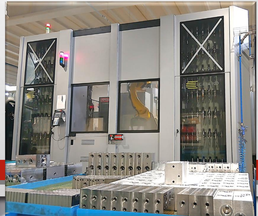
Factory-Manufacturing-System TOYODA (Bearbeitung von Stahl): Werkzeugmagazin mit 504 Werkzeugen / Fastems-Palettenlager mit 16 Stationen
