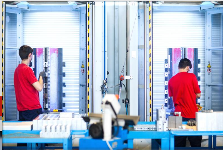
Factory-Manufacturing-System TOYODA (Bearbeitung von Aluminium): Werkzeugmagazin mit 570 Werkzeugen / Fastems-Palettenlager mit 20 Stationen.
