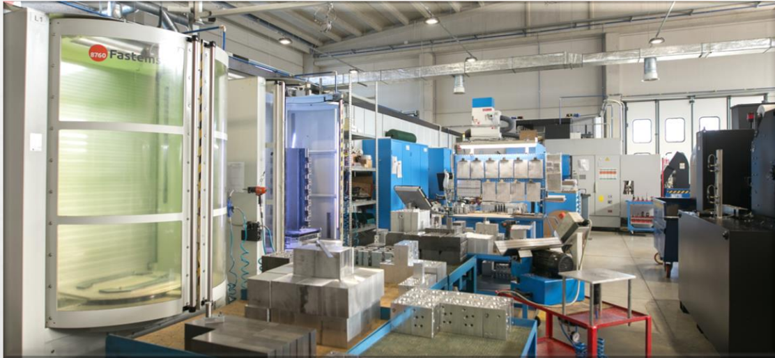
Factory-Manufacturing-System TOYODA (Bearbeitung von Aluminium): Werkzeugmagazin mit 570 Werkzeugen / Fastems-Palettenlager mit 20 Stationen.
