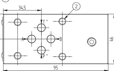
\* P e T sono invertiti quando il modulare è montato sotto sopra.
