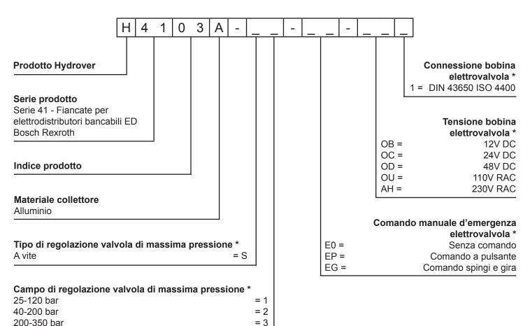
\* Omettere se non richiesto. Per esempio per ordinare il prodotto senza elettrovalvola, omettere le variabili del comando manuale d'emergenza, della tensione e della connessione elettrovalvola: H4103A-S2.
