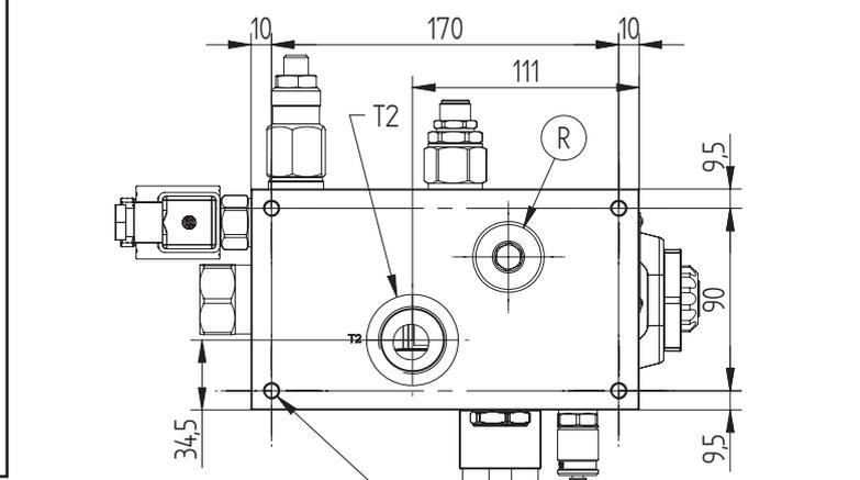
N°4 M10x15 per fissaggio blocco
