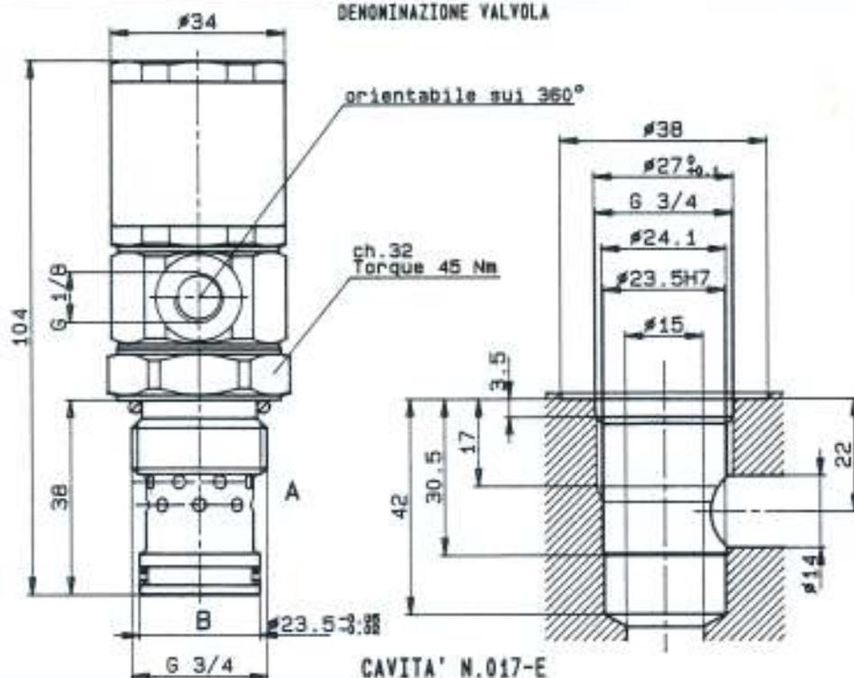
Trattasi di una nuova linea di valvole ad azionamento pneumatico, pilotate, a tenuta, particolarmente indicate per l'impiego su autocarri, su macchinario operante in condizioni climatiche estreme o laddove non e' consentito l'uso di energia elettrica. Progettate in moduli base facilmente componibili, sono caratterizzate da un basso sforzo di azionamento (equivalente a 4-5 bar) indipendente dalle pressioni e dalle portate idrauliche in gioco.
