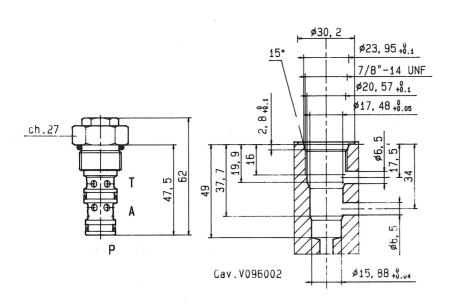
Questa valvola svolge la funzione di mettere a scarico il ramo di alimentazione generale A quando viene a mancare il flusso della pompa in P.
