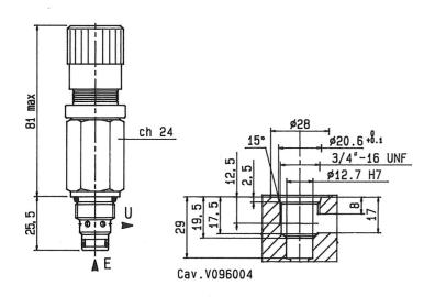
Trattasi di uno strozzatore a cartuccia compensato di piccole dimensioni particolarmente usato nei blocchi integrati.
